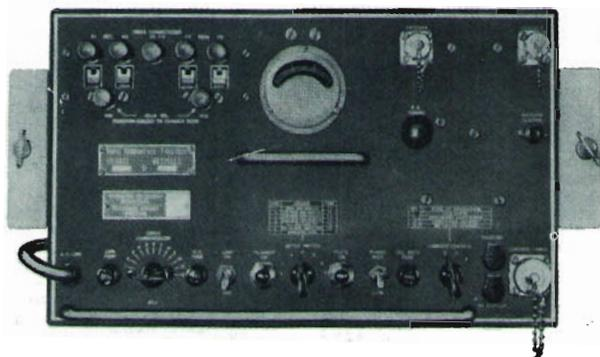
Trasmittitore T14-TRC/1-H 70 Mc - 103 Mc 50 W
